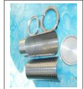
**Imágenes:** Ejemplos de molde para ladrillos con los orificios de drenaje necesarios
