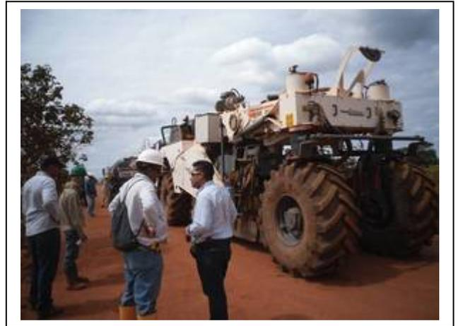
Mullir y mezclar **TERRA-3000®**- solución con una mezcladora - fresadora
